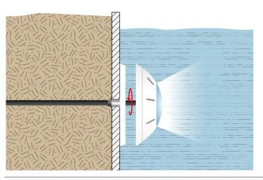
Etanchéité assurée par un presse-étoupe à l'arrière du projecteur Watertightness ensured by a gland at the back of flooglight
